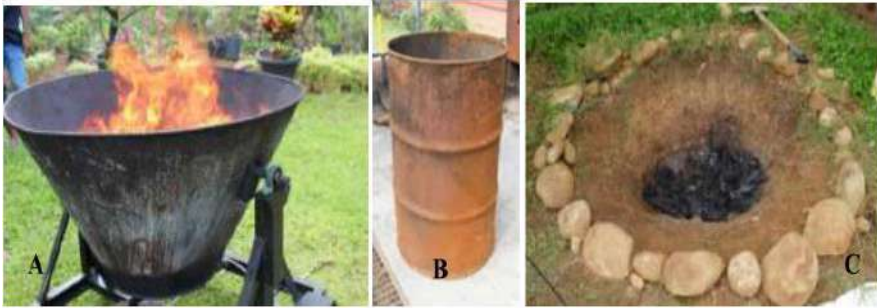
Gambar 29. Produksi biochar dengan metode (A) Kon-Tiki (B) Drum and (C) Soil-Pit.
